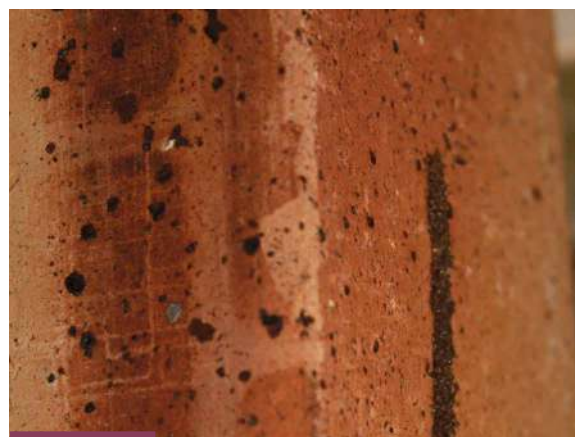
Construction d'une galerie tunnel (cordonnet) sur brique
