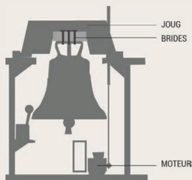
Le clocher de l'église compte quatre cloches de quatre tailles différentes. Deux d'entre elles, les plus grosses, présentaient des dysfonctionnements au niveau des jougs, des brides et des moteurs de volée, provoquant leur arrêt. Des travaux de maintenance approfondis ont été menés courant décembre. Grâce à cette intervention, les cloches ne sonnent pas plus fort mais elles bénéficient d'un registre de tonalités plus riche conférant une harmonie spécifique au tintement pouliguennais.
